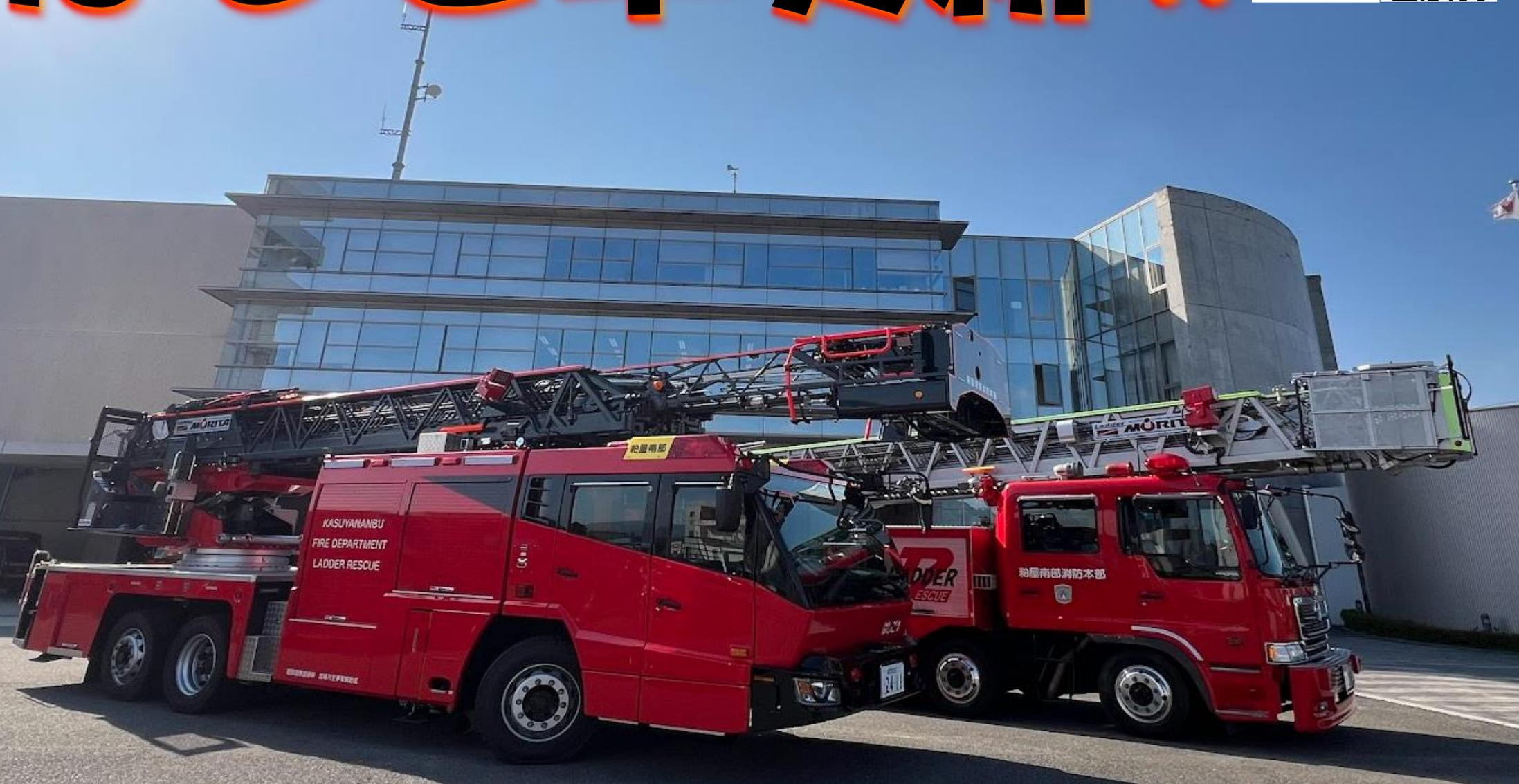
40m級はしご車(後)を 35m級先端屈折はしご車(前)に更新しました。運用開始は令和7年1月を予定しています。新型はしご車は高性能な機能を有しており、はしご車の長さは短くなったものの先端が屈折することで障害物(電線、手すり等)を回避して使用できるようになりました。詳細は公式SNSに掲載しています。
