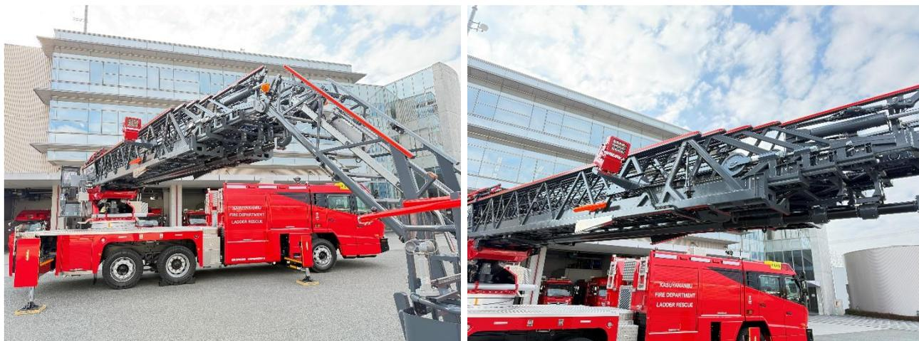
アルミ製伸縮水路管付で起伏・伸縮・旋回・屈折時でも自由に放水可能となっています。デザイン性も重視し、モリタ社製の同型はしご車では黒色梯体を日本で初めて採用しました。
