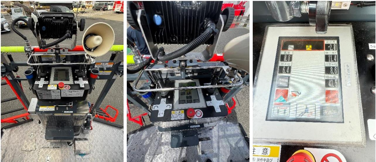
ボックス型操作装置を設け操作台同様にタッチパネル式液晶ディスプレイ、スイッチ類等の装置を装備しバスケット内でもはしご操作が可能となっています。
