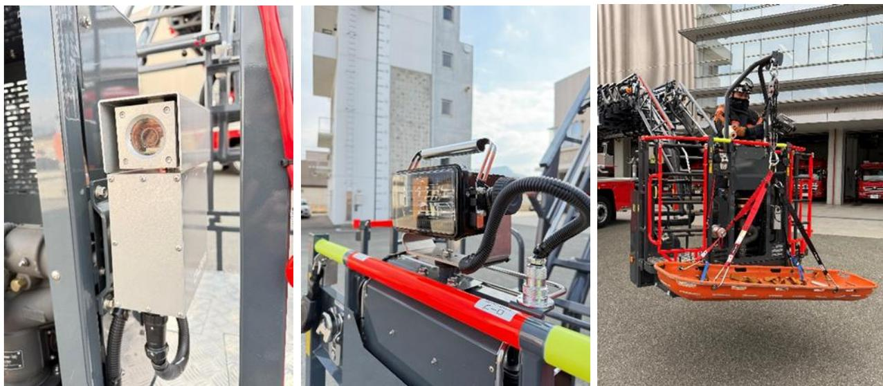
バスケットには基部操作部の液晶ディスプレイではしごの作業状況と先端カメラ映像を同時に表示し監視できるスーパーインポーズカメラを搭載、自衛噴霧ノズル、サーチライトを装備しています。また、2本のアーム（支点）を設置することで各種救助器具（担架）を設置できるようにしたことで救助活動の幅が広がりました。
